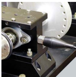
ネジでセンサーを止められます。
