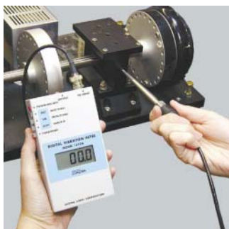
手持ちでセンサーを押し当てて計測できます。
