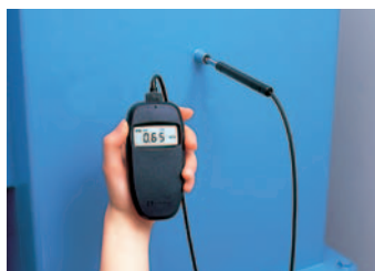
ダクト内の風量測定に…
