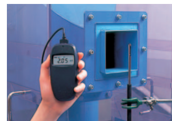
吹き出し口の風速測定に…
