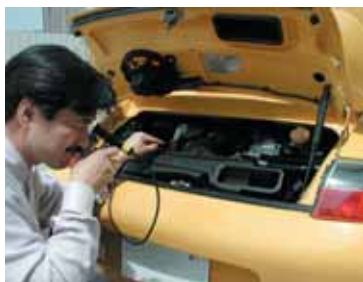
自動車エンジン内部の検査
